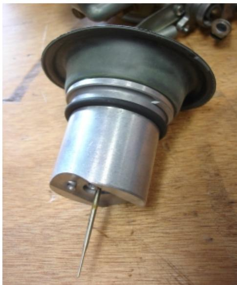
L'aiguille, le boisseau et la membrane en caoutchouc
